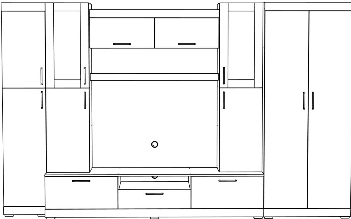
Комплект устанавливать на жесткой поверхности, в месте последующей эксплуатации. Перед тем, как соединить модули между собой, рекомендуется выставить каждый модуль по уровню. После чего сдвинуть вплотную друг к другу, и соединить. Соединённые вместе модули не рекомендуется двигать.
