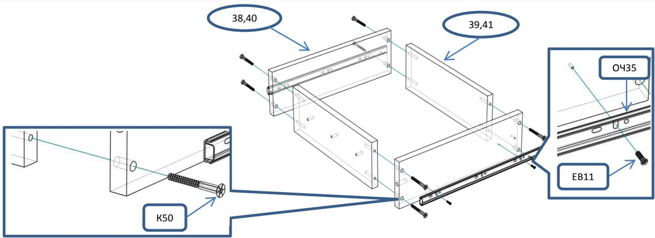
! С помощью рулетки выровнять диагонали ящика и закрепить дно
