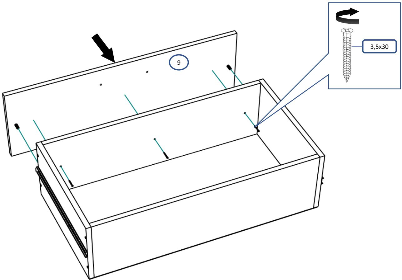
! Саморезы закрутить не утапливая, заподлицо с внутренней поверхностью передней стенки ящика
