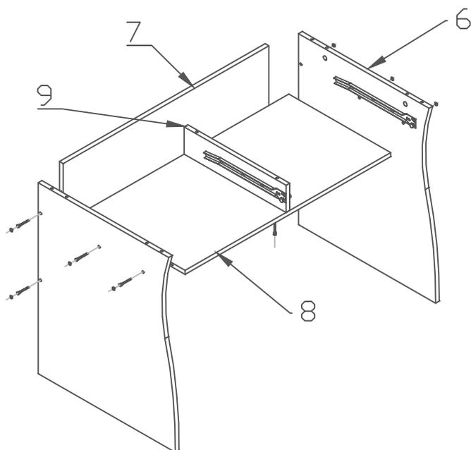
4. Прикрутить столешницу к собранной консоли на стяжки(14). Вставить шканты(19) и вкрутить винты эксцентрики(18).
