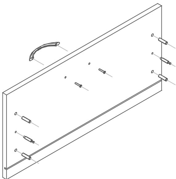
7. Собрать ящик. На фасад(10) насадить боковины(8), притянуть их эксцентриками(15), зад. стенку(9) прикрутить стяжками(14). В паз на фасаде вставить донце(11) выровнять по боковинам и зад. стенке. Прикрутить донце и направляющие(13) на саморезы(18)
