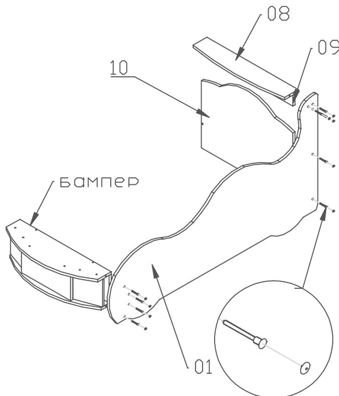
3. Вставить панель(02) между спинкой и бампером, торцевым отверстием назад. Прикрутить к спинке стяжками(12) с заглушками(13) к боковине саморезами(14). Прикрутить механизм(16) по наметке на саморезы(15). Верхняя площадка параллельно панели(02), задний край на 5мм от спинки.
