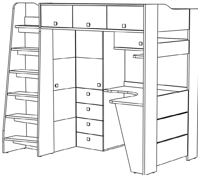
Комплект устанавливать на жесткой поверхности, в месте последующей эксплуатации. Перед тем, как соединить модули между собой, рекомендуется выставить каждый модуль по уровню. После чего сдвинуть вплотную друг к другу, и соединить. Соединённые вместе модули не рекомендуется двигать. Установку производить вдвоём !
