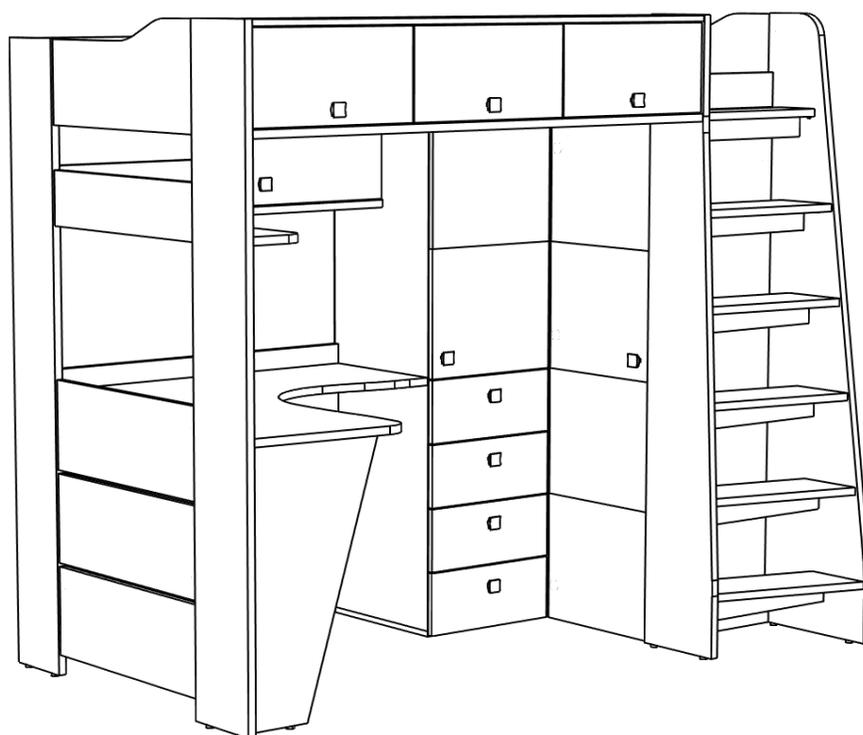
Комплект устанавливать на жесткой поверхности, в месте последующей эксплуатации. Перед тем, как соединить модули между собой, рекомендуется выставить каждый модуль по уровню. После чего сдвинуть вплотную друг к другу, и соединить. Соединённые вместе модули не рекомендуется двигать. Установку производить вдвоём !
