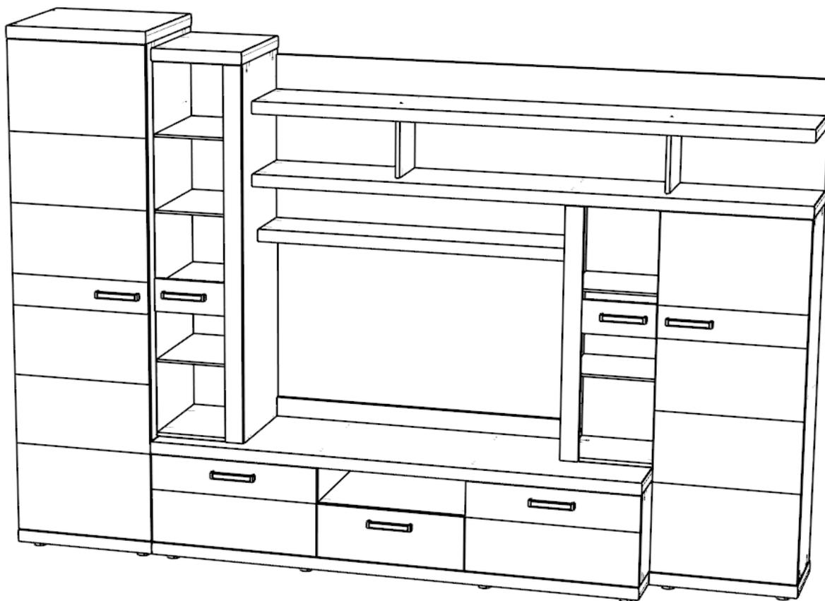
Комплект устанавливать на жесткой поверхности, в месте последующей эксплуатации. Перед тем, как соединить модули между собой, рекомендуется выставить каждый модуль по уровню. После чего сдвинуть вплотную друг к другу, и соединить. Соединённые вместе модули не рекомендуется двигать.
