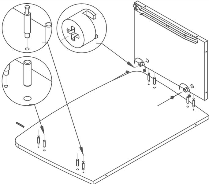
5. Прикрутить донце(6) тумбы на стяжки(14). С ножек(19) срезать заглушки, вставить ножки в отв. 10мм.
