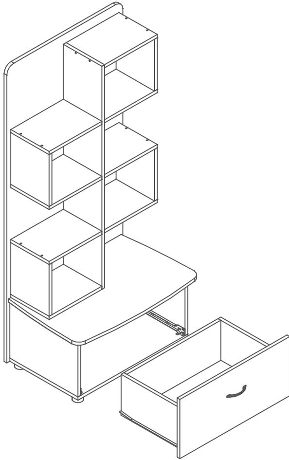
1. Полочный модуль. Установка полок(3) на стойку(2). По 1 стяжке(14) на полку, Полки плотно притянуть, затем развернуть в горизонтальное положение.
