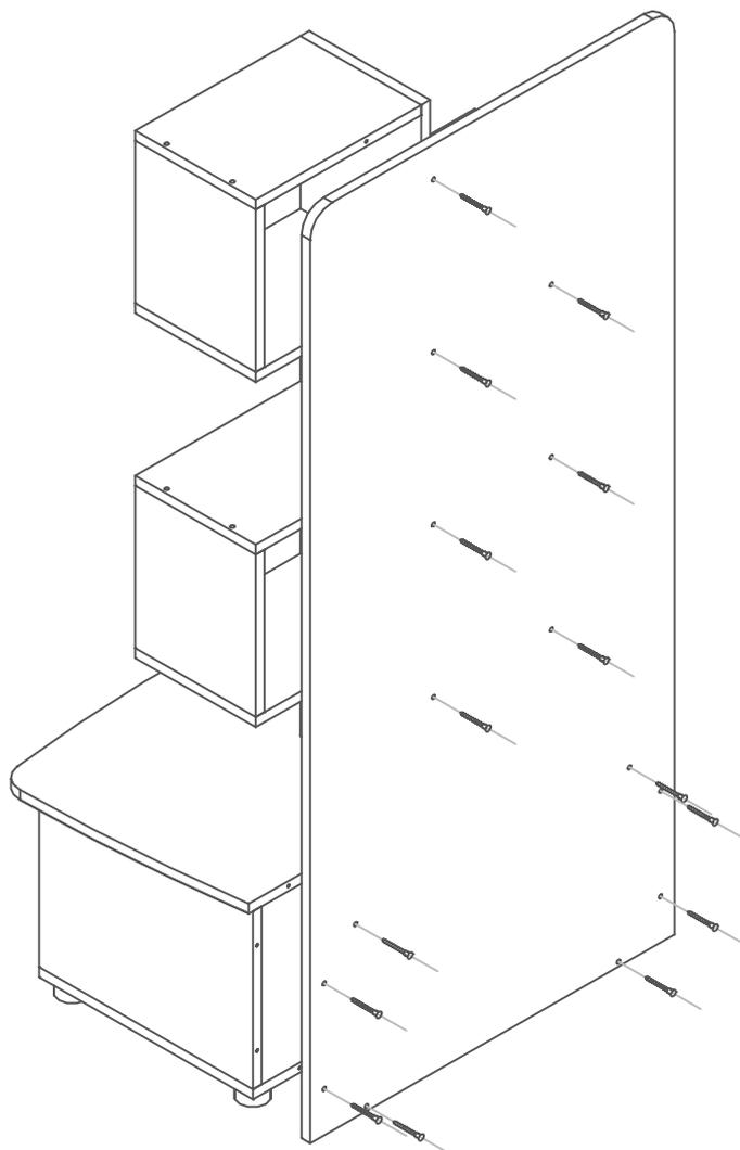
7. Собрать ящик. На фасад(10) насадить боковины(8), притянуть их эксцентриками(15), зад. стенку(9) прикрутить стяжками(14). В паз на фасаде вставить донце(11) выровнять по боковинам и зад. стенке. Прикрутить донце и направляющие(13) на саморезы(18)
