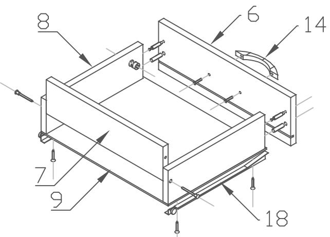
4. Вставить ящик в тумбу. При необходимости отрегулировать зазоры фасада сместить передний край направляющей выше или ниже.
