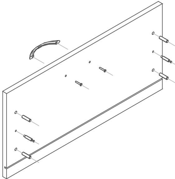
8. К задней стенке(1) сначала наживить, а затем прикрутить до конца тумбу и полочный модуль на стяжки(14)
