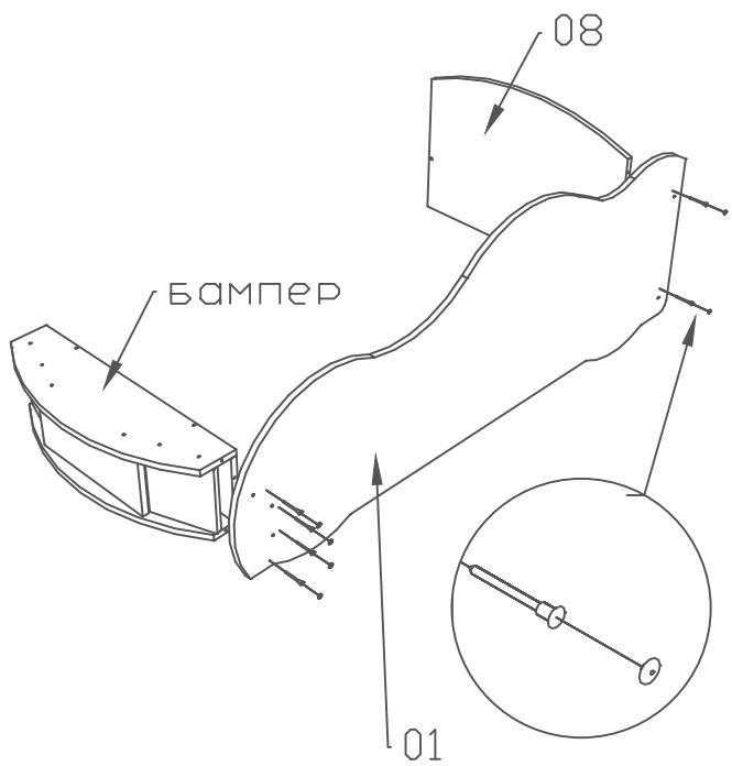
3. Вставить панель(02) между спинкой и бампером, торцевым отверстием назад. Прикрутить к спинке стяжками(12) с заглушками(11) к боковине саморезами(14). Прикрутить механизм(14) по наметке на саморезы(13). Верхняя площадка параллельно панели(02), задний край на 5мм от спинки.
