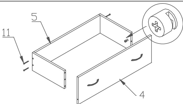
7. Ящики задвинуть в комод. Проверить зазоры между фасадами. По необходимости отрегулировать высоту переднего края направляющей.
