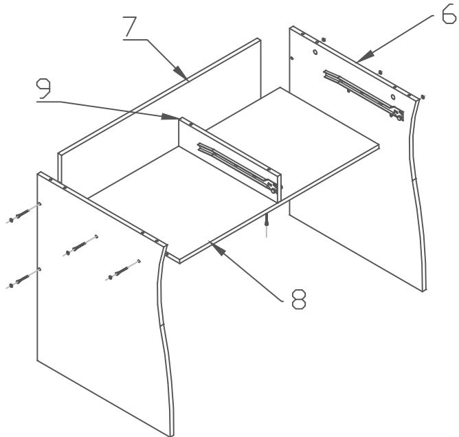
5. Столешницу насадить на боковины стола и пергородку(9), винты(18) притянуть эксцентриками(17), на нижние торцы боковин стола прикрутить ножки(22) саморезами(16).
