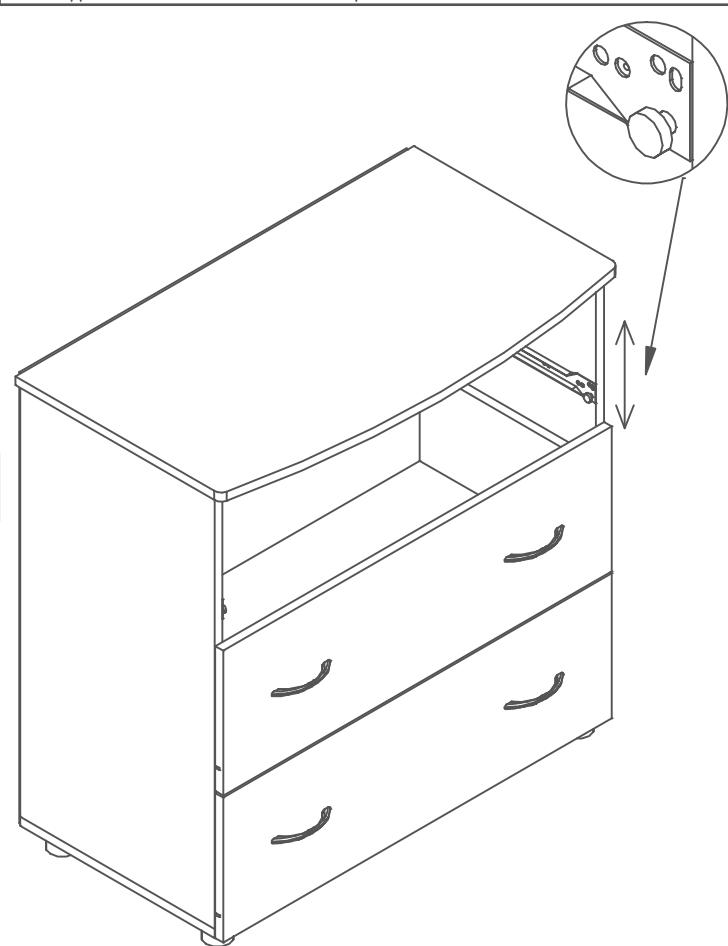
6. Донце(8) задвинуть в паз на фасаде, выровнять по стенкам ящика и прикрутить саморезами(15) вместе с направляющими(10)
