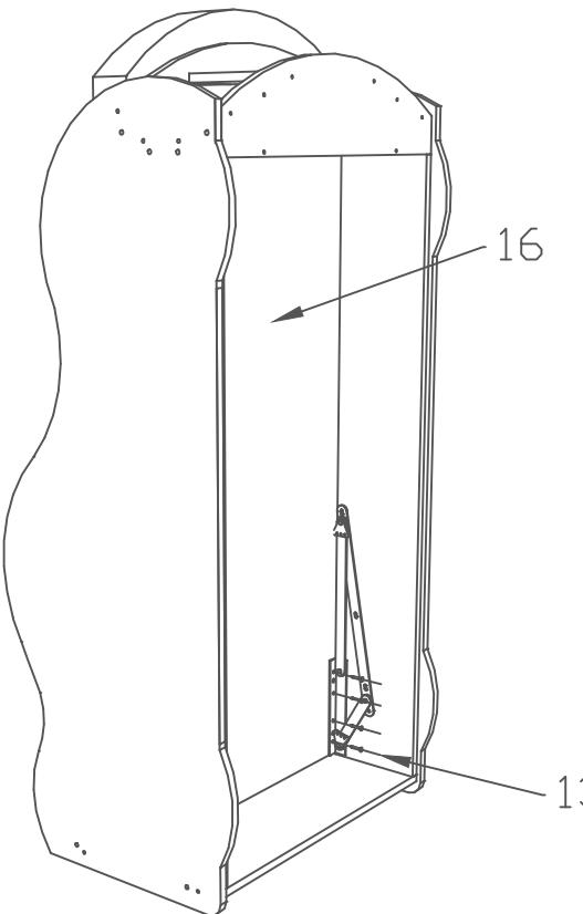
5. Прикрутить донце(09) на саморезы(12) по периметру. В торцы бок. панелей спинки и бампера.
