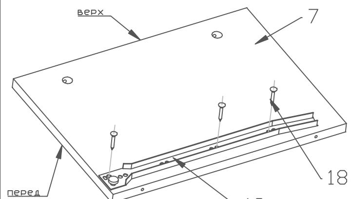
4. В крышку тумбы(5) вкрутить винты(16) и вставить шканты(17), установить на них боковины(7) и зафиксировать эксцентриками(15).
