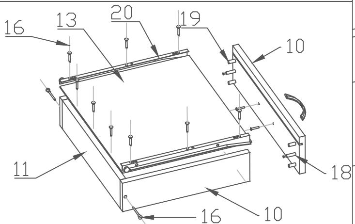
4. Прикрутить столешницу к собранной консоли на стяжки(14). Вставить шканты(19) и вкрутить винты эксцентриков(18).
