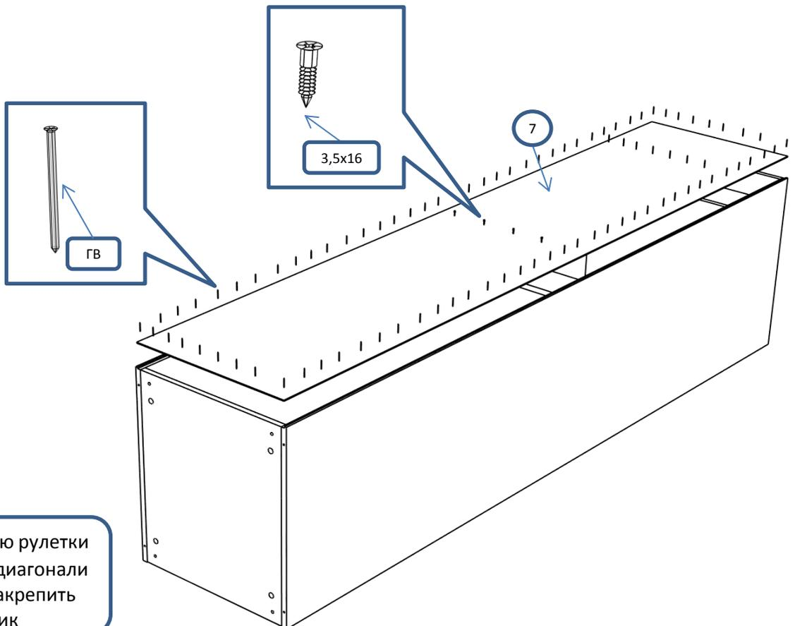
**!** С помощью рулетки выровнять диагонали шкафа и закрепить полки
