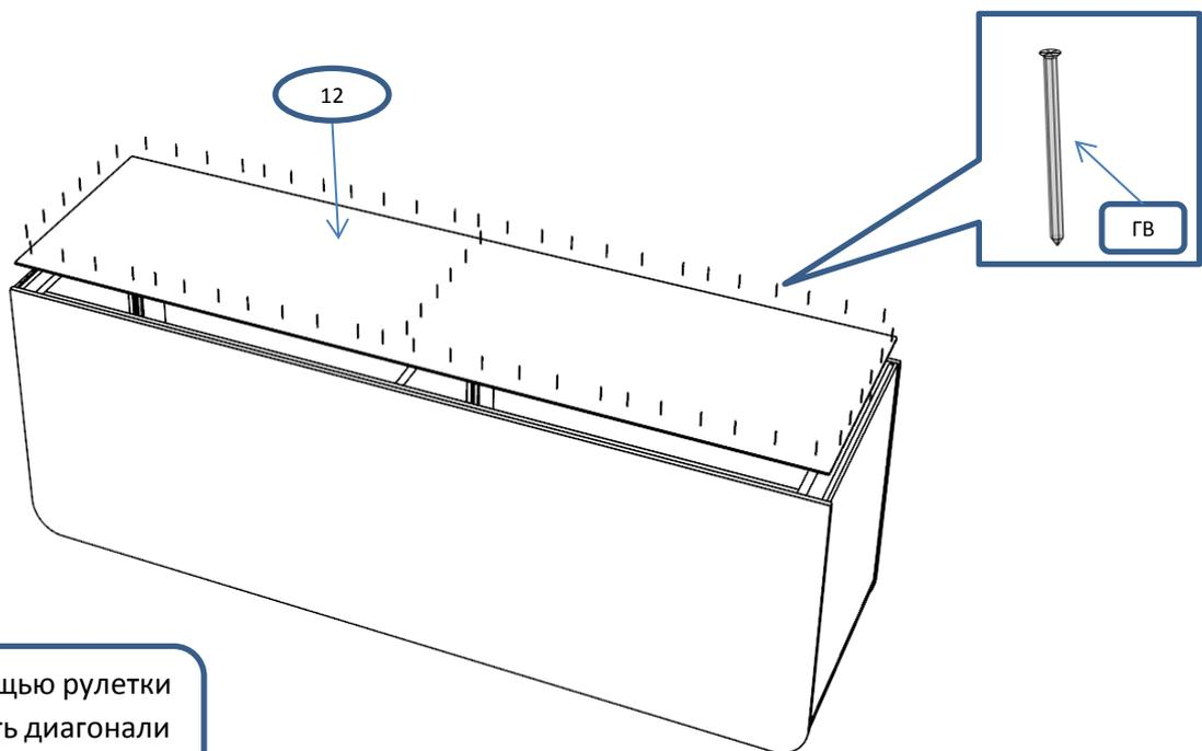
! С помощью рулетки выровнять диагонали тумбы и закрепить полки
