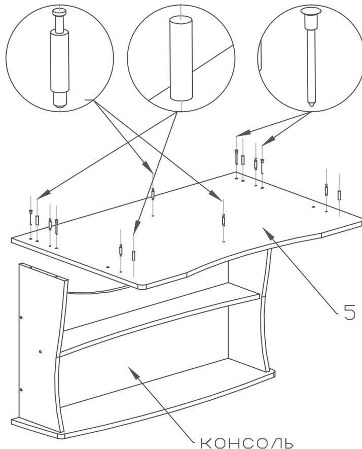
5. Столешницу насадить на боковины стола и перегородку(0), винты(18) притянуть эксцентриками(17), на нижние торцы боковин стола прикрутить ножки(22) саморезами(16).
