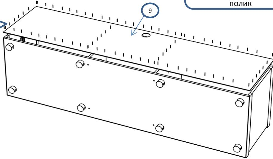
! С помощью рулетки выровнять диагонали тумбы и закрепить полки
