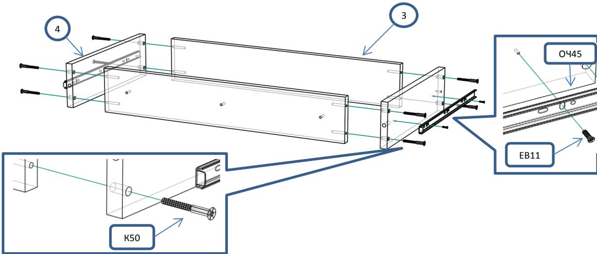
! С помощью рулетки выровнять диагонали ящика и закрепить дно
