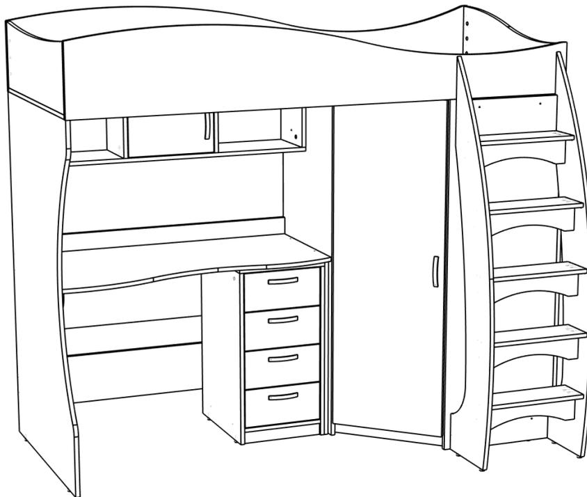
Комплект устанавливается на жесткой поверхности, в месте последующей эксплуатации. Перед тем, как соединить модули между собой, рекомендуется выставить каждый модуль по уровню. После чего сдвинуть вплотную друг к другу, и соединить. Соединённые вместе модули не рекомендуется двигать.
