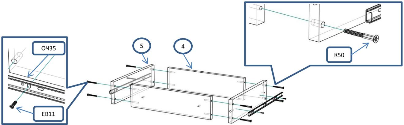
! С помощью рулетки выровнять диагонали ящика и закрепить дно
