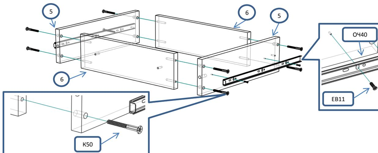
! С помощью рулетки выровнять диагонали ящика и закрепить дно
