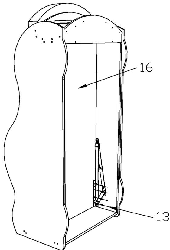
5. Прикрутить донце(09) на саморезы(12) по периметру. В торцы бок. панелей спинки и бампера.
