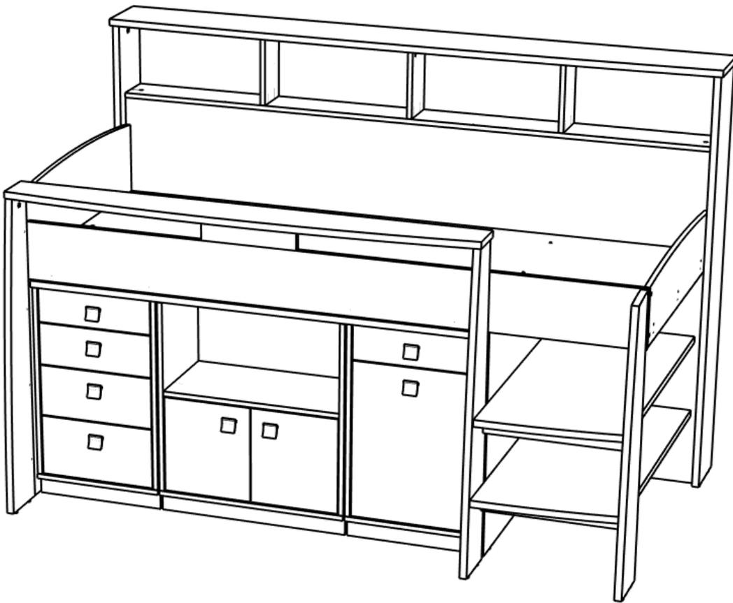
Сборка задней стенки и полки
