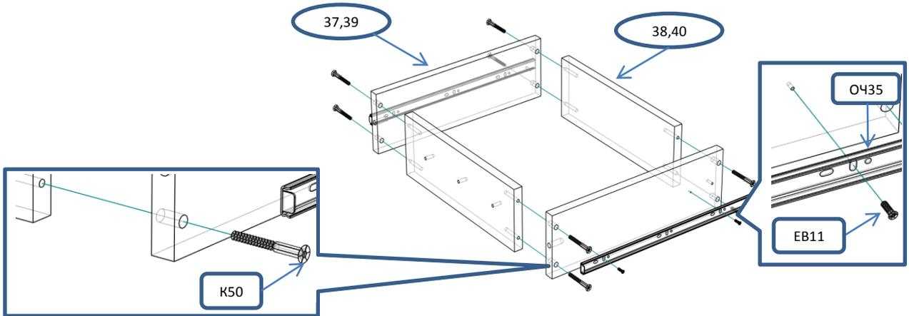
! С помощью рулетки выровнять диагонали ящика и закрепить дно
