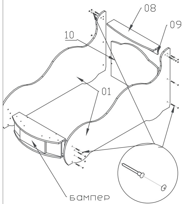
3. Вставить панель(02) между спинкой и бампером, торцевым отверстием назад. Прикрутить к спинке стяжками(12) с заглушками(13) к боковине саморезами(15/2). Прикрутить механизм(16) по наметке на саморезы(15/1). Верхняя площадка параллельно панели(02), задний край на 5мм от спинки.
