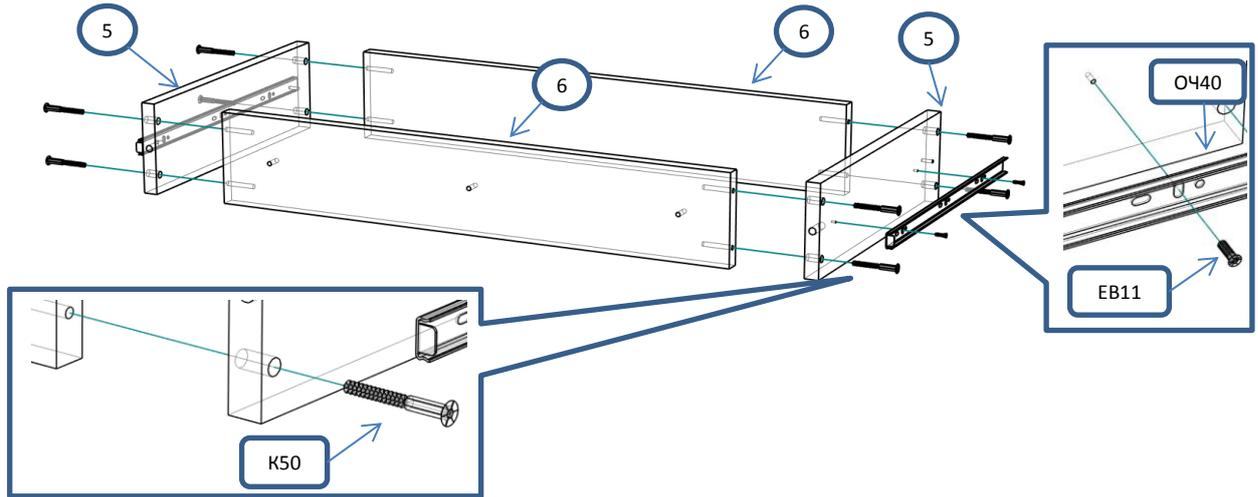
! С помощью рулетки выровнять диагонали ящика и закрепить дно
